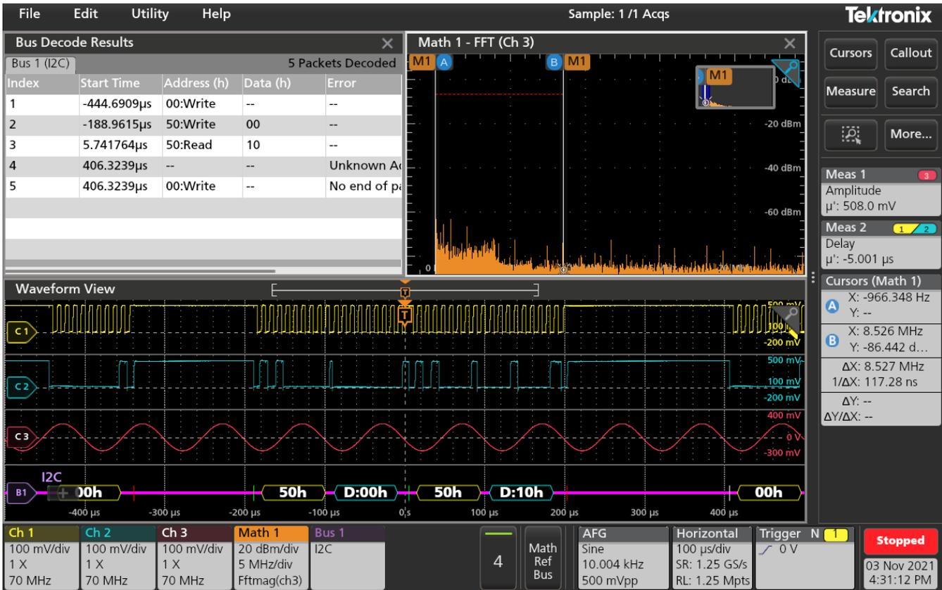
고도로 사용자 정의 가능한 사용자 인터페이스를 통해 아날로그 채널, 디코딩된 직렬 버스 파형, 결과 표, 측정 결과, 수학 FFT 플롯 및 커서 판독값을 각 입력에 대한 설정 정보와 함께 동시에 볼 수 있습니다.
